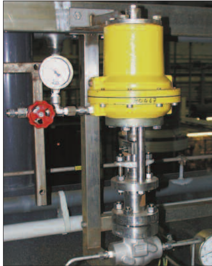
Привод В825 для клапана модели 2100В - \text{D}_2\text{O} /изоляция линий тяжелой воды
